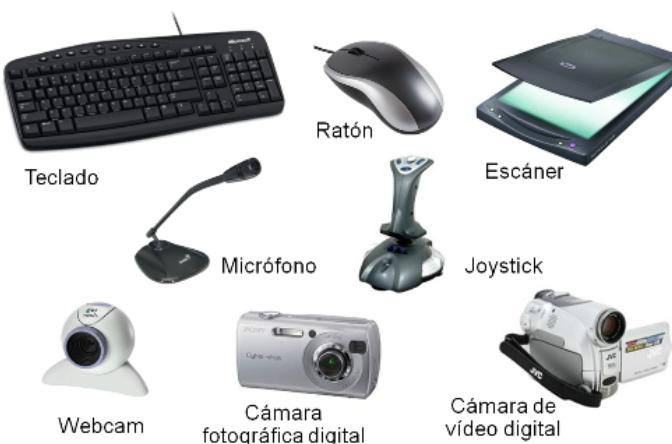
Son todos aquellos accesorios o equipos que le permiten al usuario ingresar información al computador para que sea procesada. El principal periférico de entrada es el Teclado, pero existen otros dispositivos de entrada, como por ejemplo: el mouse (ratón), el escáner, cámara web, lector de código de barras, el micrófono, joystick, pantalla sensible al tacto (táctil), sistema de reconocimiento de voz y lápiz óptico.
