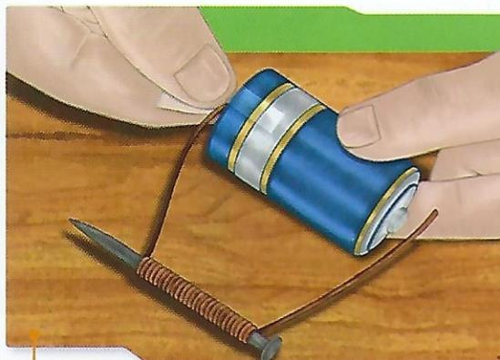
**3** Se sujeta uno de los extremos del cable a uno de los terminales o polos de la pila con la cinta pegante. El otro extremo del cable se deja libre para controlar el electroimán.
