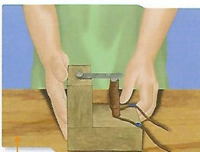
**5** Fijamos la placa metálica a la madera con un chinche. El extremo libre quedará sobre la puntilla del electroimán.
