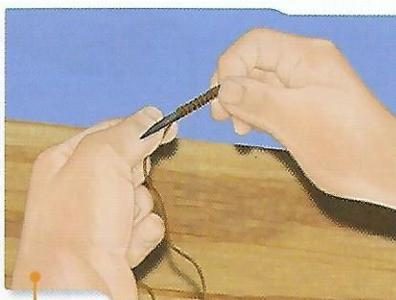
**2** Construimos la bobina con los 3 metros de alambre esmaltado calibre No. 28. Observamos la imagen.
