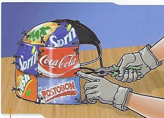
**4** Forramos la estructura con las láminas elaboradas con las latas. Las amarramos con alambre dulce delgado.
