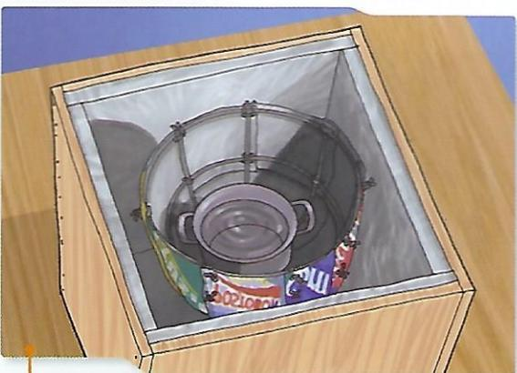
**5** Colocamos la estructura dentro de la caja, y dentro de ella colocamos una olla pequeña.
