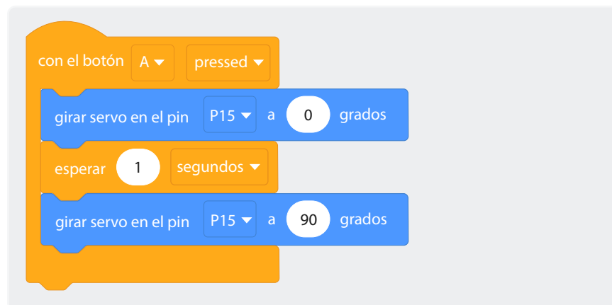
Figura 2. Programación acciones con entradas A y B
