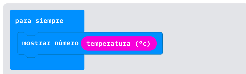
Figura 1. Código en MakeCode para mostrar continuamente el valor medido de temperatura
