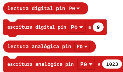
Figura 10. Bloques de uso de los pines: lectura y escritura digital y analógica
